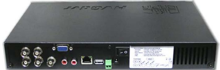
Вид сзади (входы видео и звука, VGA выход, выходы видео и звука, локальная сеть, USB, RS-485, вход питания 12 В, выкл. питания)
