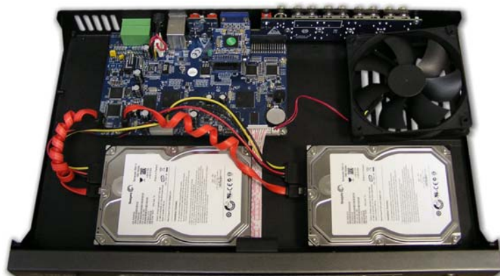
Устройство видеорегистратора – установлено 2 жестких диска
