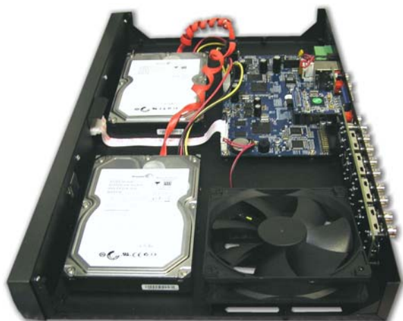
Система вентиляции на база вентилятора диаметром 12 см
