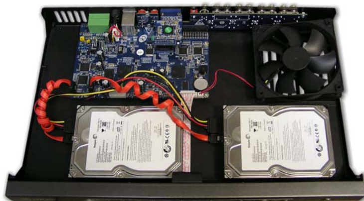
Устройство видеорегистратора – установлено 2 жестких диска
