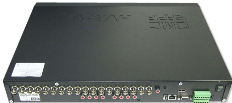
Вид сзади. Входы и выходы видео и звука, вход USB, сеть, выходы HDMI, VGA, тревожные вх/вых., RS-232, RS-485, вход питания 12 В
