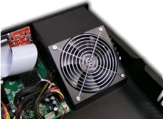
Система вентиляции на базе вентилятора диаметром 12 см
