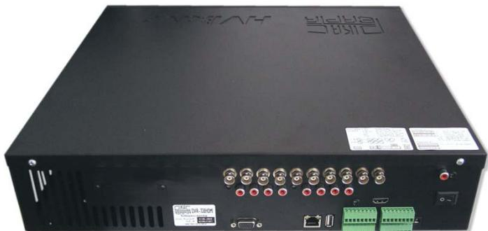
Вид сзади входы видео и звука, выход VGA, сеть, USB, тревожные входы/выходы с RS-232 и RS-485, вход питания 12 В, видео- и аудио выход
