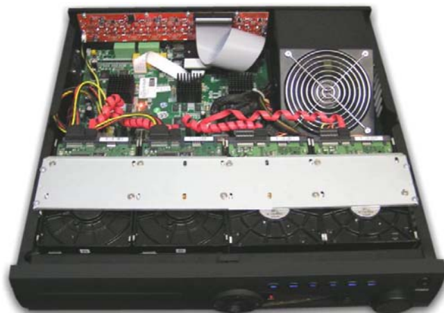
Устройство видеорегистратора – установлено 4 жестких дисков
