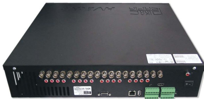
Вид сзади входы видео и звука, выход VGA, сеть, USB, тревожные входы/выходы с RS-232 и RS-485, вход питания 12 В, видео- и аудио выход
