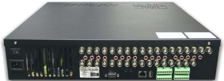
Вид сзади (вход питания 220 В, входы видео, входы звука, выход видео, VGA, HDMI, сеть, USB, тревожные входы/выходы, RS-232, RS-485)
