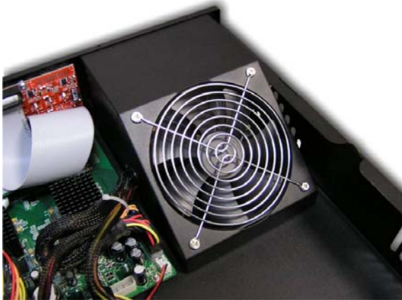
Система вентиляции на база вентилятора диаметром 12 см
