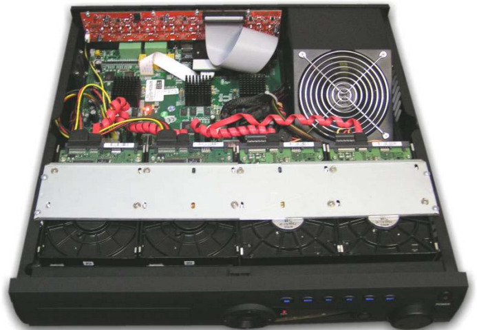
Устройство видеорегистратора – установлено 8 жестких дисков
