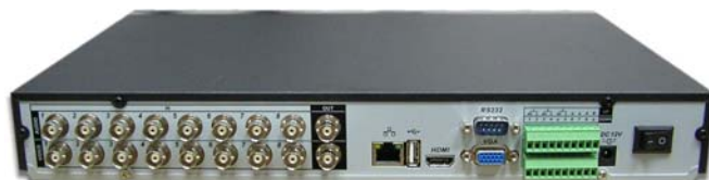
Вид сзади (входы видео и звука, выходы видео и звука, сеть, USB, HDMI, VGA, RS-232, входы-выходы тревог, RS-485, вход питания 12 В)
