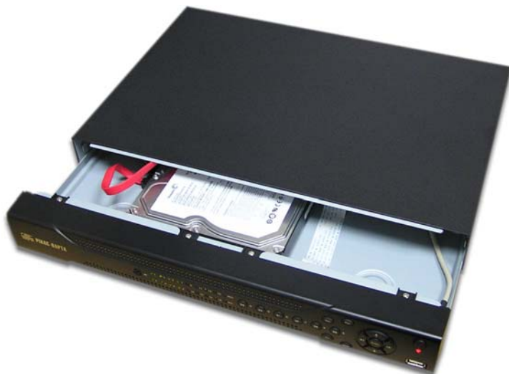
Стальной корпус (толщина 0,8 мм). Удобная сдвигаемая крышка
