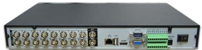
Вид сзади (входы видео и звука, выходы видео и звука, сеть, USB, HDMI, VGA, RS-232, входы-выходы тревог, RS-485, вход питания 12 В)
