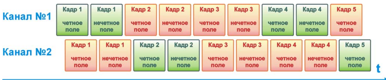
Рисунок 2.б. Схема работы платы в режиме мультиплицирования при обработке кадров.
