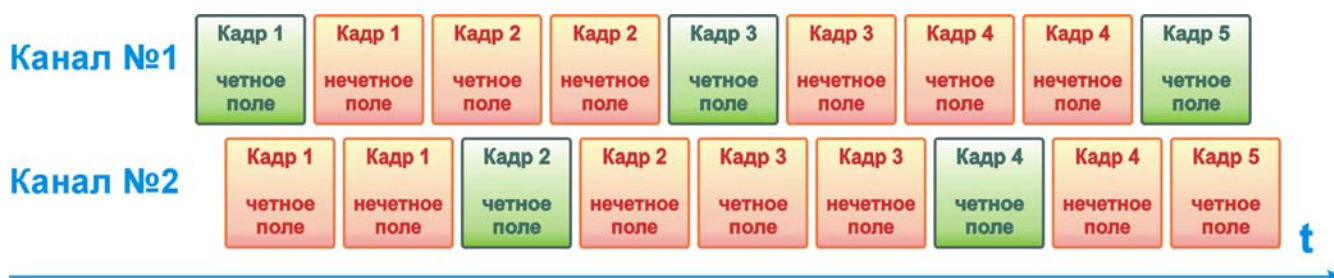
Рисунок 2.а. Схема работы платы в режиме мультиплицирования при обработке полей.
