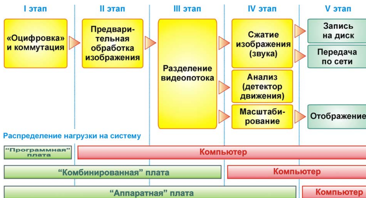
Рисунок 1. Этапы обработки видеоизображения в системе видеорегистрации.
