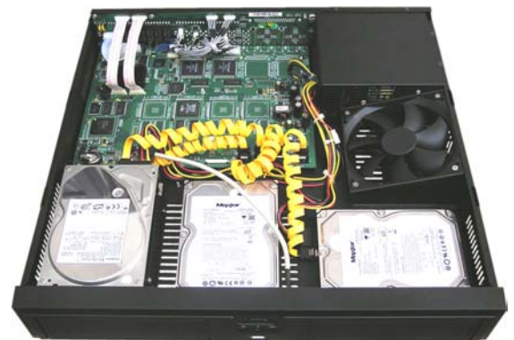
Размещение 4 жестких дисков в корпусе регистратора
