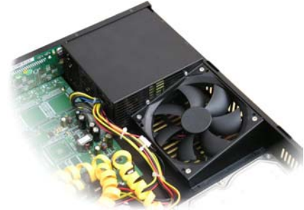
Источник питания с пассивным охлаждением и 120 мм вентилятор корпуса
